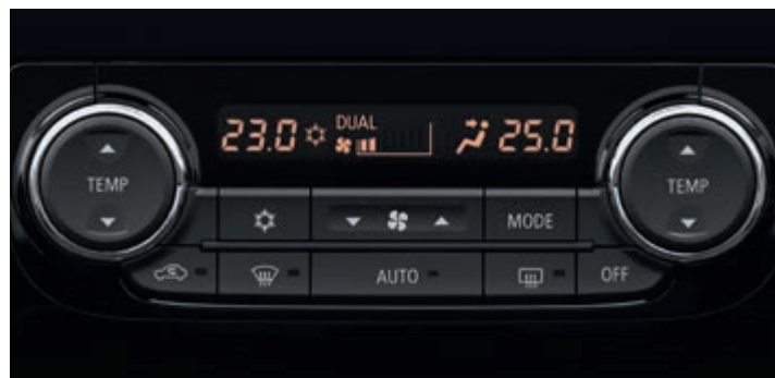
Автоматичний 2-зонний клімат-контроль
