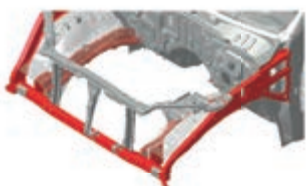
Посилені елементи каркасу моторного відсіку
